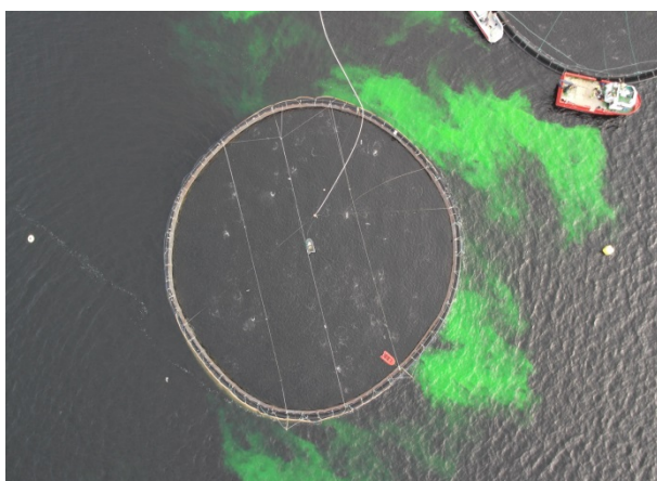
Fig. 5 Fullskala forsøk med fargestoff for å undersøke strømningene i og omkring en produksjonsmerd med påmontert skjørt.
